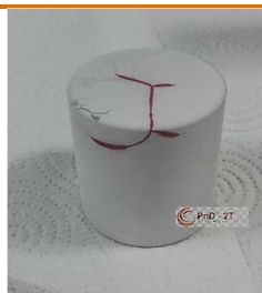
Ispezioni PT su barre in acciaio
