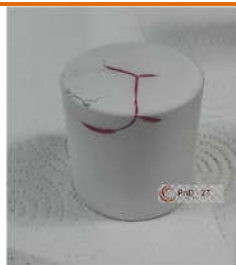
Ispezioni PT su barre in acciaio
