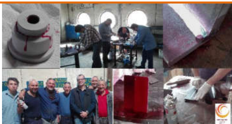
Corso liquidi penetranti a contrasto di colore – GC Spa Luglio 2016
