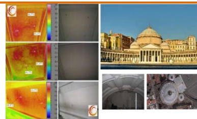
Rilevi termografici presso Basilica Reale pontificia San Francesco da Paola – Piazza Plebiscito (Na)
